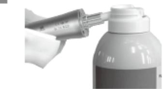
将喷嘴插入到牙科手机的连接末端, 紧紧握住, 然后喷大约 2 秒。
