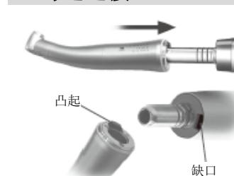
将牙科手机直接推到马达连接柱上，直到你听到卡到位的声音。（光纤在此时不会转动。）然后转动牙科手机，直到其上的凸起与马达的缺口成一条直线。凸起与缺口成一条直线时会有咔哒声。
