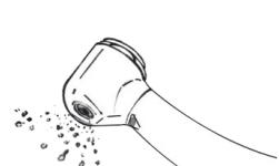
将手机与软管连接。让手机工作至少 15 秒，排掉机头多余的润滑油，然后用纱布擦拭干净。将手机从软管上拆下。
