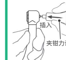
将卡盘试验棒笔直插入，直至接触到卡盘机构。
