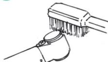
从手机卸下钻针，然后将手机从软管上拆下。在流动的水源下用软刷清洗切削及其他碎屑。
