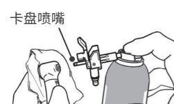
用纱布垫在机头部，将卡盘喷嘴尖端插入钻针插孔，喷射 2 秒。
