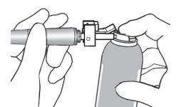
将喷嘴插入手机连接部，牢牢固定，然后喷射 2 秒。
