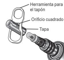
Apague el interruptor principal de la unidad de tratamiento odontológico. Retire la cubierta usando el orificio cuadrado de la herramienta para el tapón.
