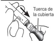
Sostenga la tuerca de la cubierta y deslice la pieza de mano directamente sobre el acoplamiento hasta que quede firmemente ajustado en la posición correcta (escuchará un clic).
