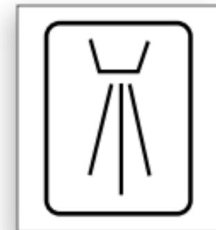
Morita Instrumente mit diesem Symbol sind sowohl für die maschinelle Reinigung und Desinfektion mit einem Thermodesinfektor (RDG) als auch für die manuelle Innenreinigung und -desinfektion mit WL-clean und WL-cid geeignet.
