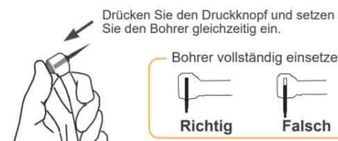
Drücken Sie den Druckknopf fest nach unten und führen Sie den Bohrer gleichzeitig bis zum Anschlag ein.
