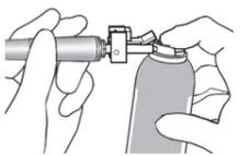
Insérer le bec pulvérisateur côté connexion dans la pièce à main, la tenir fermement et vaporiser pendant 2 secondes.
