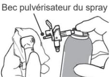
Recouvrir la tête de la pièce à main de gaze, insérer l'extrémité du bec pulvérisateur dans l'orifice de la fraise correspondante, puis pulvériser pendant 2 secondes.
