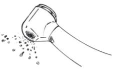
Raccorder la pièce à main au tuyau. Faire fonctionner la pièce à main pendant au moins 15 secondes pour éliminer l'excès d'huile de la tête, puis l'essuyer avec un morceau de gaze. Démontez la pièce à main du tuyau.
