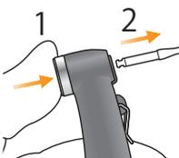
(5) Serrer fermement la vis, puis maintenir le bouton-poussoir enfoncé et retirer la barre de guidage.
