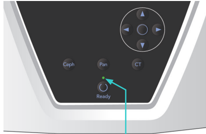
Led care indică starea „gata de funcționare”
