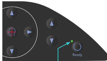
Led care indică starea „gata de funcționare”
