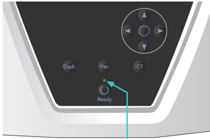
Led care indică starea „gata de funcționare”
