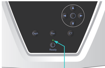
Led care indică starea „gata de funcționare”
