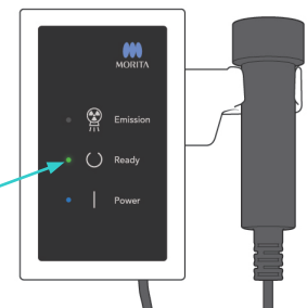
Led care indică starea „gata de funcționare”
