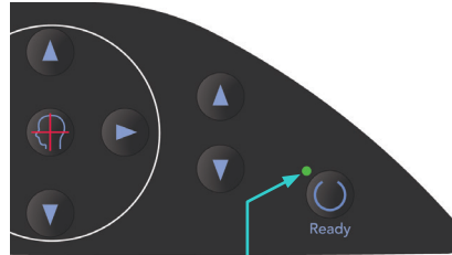
Led care indică starea „gata de funcționare”
