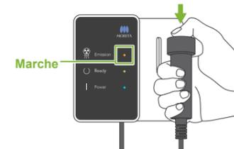
L'exposition démarre au bout de quelques secondes. La fente céphalométrique se déplace. Le voyant (jaune) Emission (Émission) du module de commande s'allume et la mélodie retentit.
