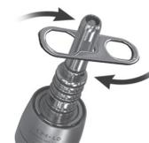
Visser de nouveau le capot en position, d'abord à la main, puis à l'aide de l'orifice carré de l'outil d'embout.
