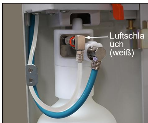
(13) Schließen Sie den weißen Luftschlauch in seiner ursprünglichen Position an.
