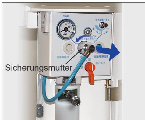
(11) Lockern Sie die Sicherungsmutter und trennen den blauen Wasserschlauch von der Flasche.
