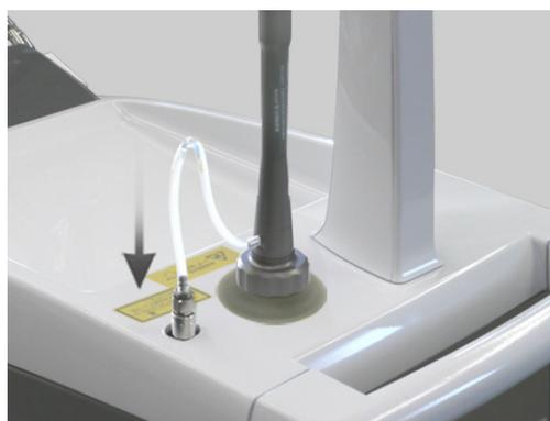
Si le tuyau d'eau n'est pas raccordé au connecteur d'eau de pulvérisation, branchez-le jusqu'à ce qu'il s'enclenche.
