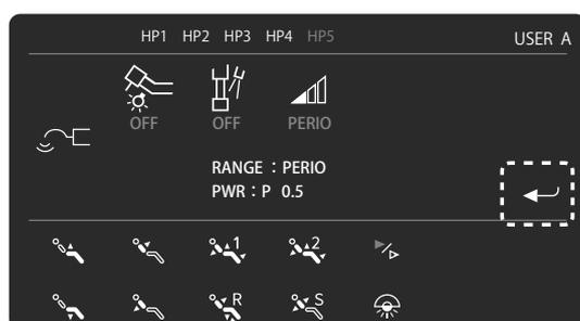
① Effectuez une pression sur l'icône Entrée sur l'écran de réglage du détartreur ultrasonique.
