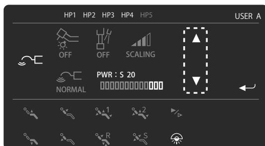
② Appuyez sur les flèches Haut/Bas pour modifier la valeur de puissance. (Lorsque la valeur 0 est sélectionnée, le détartreur ne vibre pas.)
