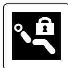
Appuyez sur l'interrupteur de verrouillage du fauteuil si vous souhaitez désactiver les fonctions du fauteuil. (Le voyant situé sur l'interrupteur reste allumé lorsque le fauteuil est verrouillé.)
