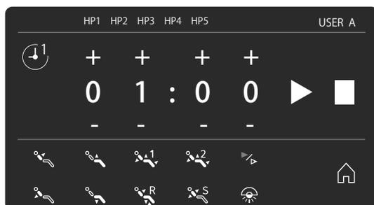
③ L'écran de réglage du minuteur s'affiche. Réglez le délai souhaité à l'aide des signes + et-. (chiffres des minutes : réglables par incréments de 1, chiffres des secondes : réglables par incréments de 1) Le délai maximal pouvant être défini est de 59 minutes et 59 secondes.
