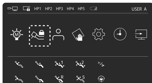
① Effectuez une pression sur l'icône de verrouillage d'instrument.
