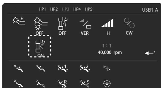
Effectuez une pression sur l'icône d'air comprimé pour activer/désactiver l'air comprimé.
