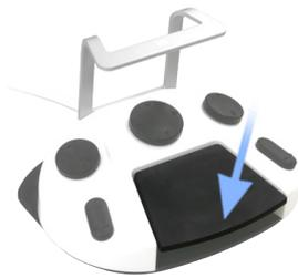
**Betätigen Sie das Pedal am Fußschalter, um die Scaling-Spitze zum Vibrieren zu bringen. Lassen Sie das Pedal los, um die Vibration zu stoppen.**
