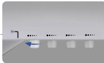
Die Drehknöpfe zur Einstellung der Spray-Durchflussmenge befinden sich unter der Ablage.
