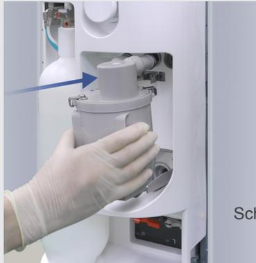
Richten Sie die Führung an der Unterseite des Vakuumtanks mit der Schiene aus und drücken den Tank in Position.
