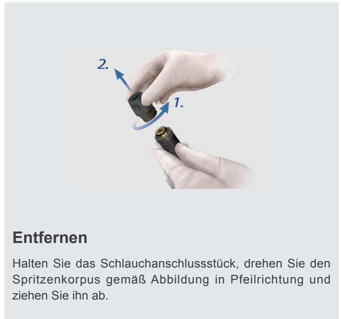
⚠ Drehen Sie den Adapter, um ihn abzunehmen oder aufzusetzen. Ein Drehen des Schlauchanschlussstücks kann dieses beschädigen.
