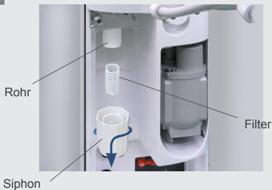
Schalten Sie den Behandlungsstuhl aus. Drehen Sie den Siphon in Pfeilrichtung (siehe Abbildung) und nehmen Sie ihn dann zusammen mit dem Filter ab. Reinigen Sie Siphon und Filter unter fließendem Wasser.
