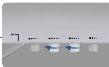
Der Drehknopf zur Einstellung der Spray-Durchflussmenge befindet sich unter der Ablage. Drehen Sie den Knopf in Pfeilrichtung, um den Durchfluss zu erhöhen.
