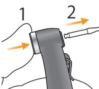
(5) Ziehen Sie die Schraube fest an, drücken Sie dann den Druckknopf und ziehen das Führungswerkzeug heraus.
