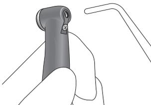
Blasen Sie verbleibende Feuchtigkeit an der Oberfläche oder im Inneren der Teile mit Druckluft aus.
