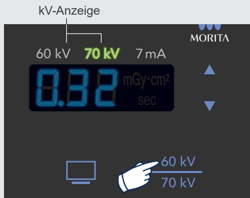
Wählen Sie einen kV-Wert. Durch Drücken der Taste wird zwischen 60 kV und 70 kV umgeschaltet.
