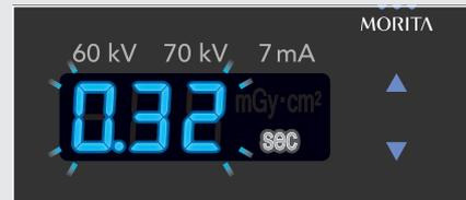
Wenn die Aufnahme abgeschlossen ist, stoppt der Aufnahmesummer und die Aufnahmeanzeige geht aus. Zusätzlich blinkt die Anzeige Ready (grün) und die Timer-Anzeige zeigt abwechselnd die gewählte Belichtungszeit und die Flächendosis.
