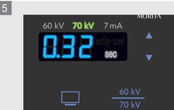
Die Belichtungszeit (in Sekunden) wird auf der Anzeige angezeigt. Die Belichtungszeit für die gewählten Parameter erscheint automatisch auf der Anzeige.
