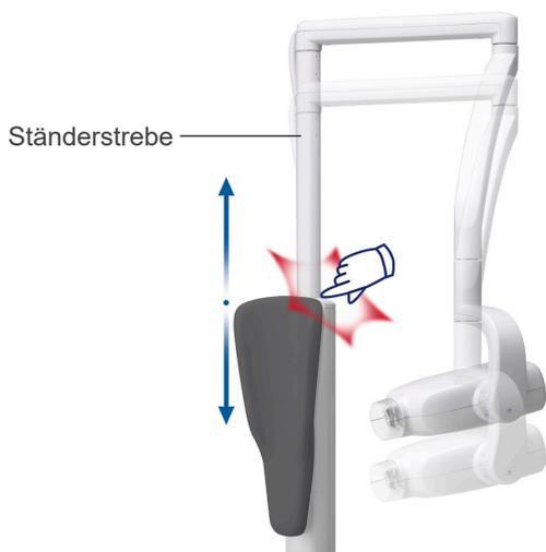
Verschieben Sie das Gestänge nach oben oder unten um die Höhe des Röntgenkopfes anzupassen.
