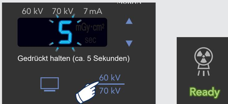
Zum Aufrufen des Einstellmodus drücken Sie die kV-Taste und halten Sie sie gedrückt (ca. fünf Sekunden), bis Sie Pieptöne hören.
